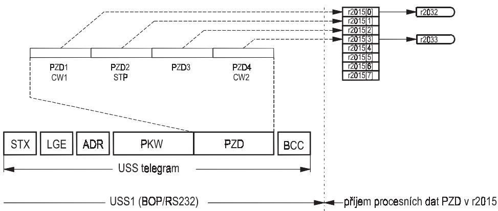
Obr. 66 Příjem dat PZD přes USS1
