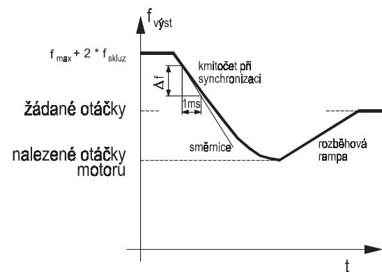
Obr. 49 Rychlosť synchronizacie na otáčejúci sa motor
