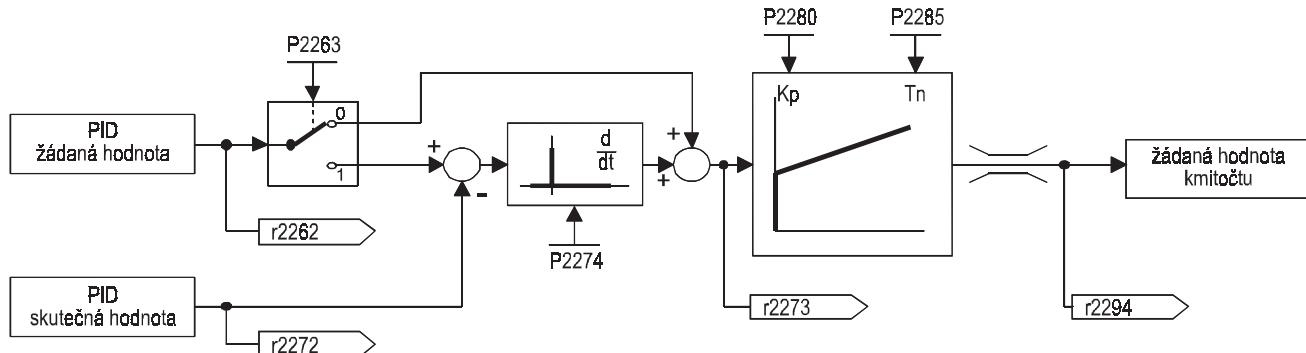
Obr. 84 PID regulátor
