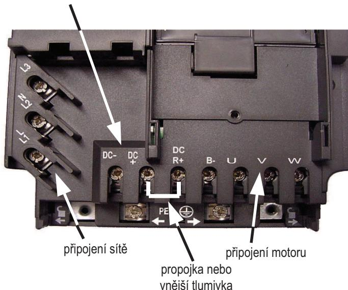
Obr. 7 Silová svorkovnice měničů velikosti C
