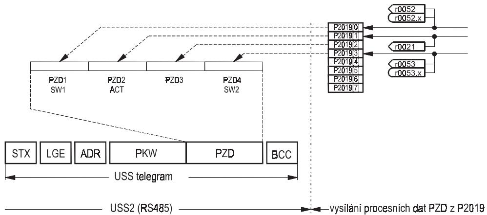
Obr. 69 Vysílání dat PZD přes USS2
