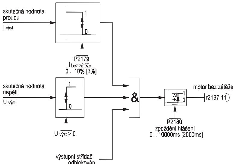
Obr. 79 Hlídání odlehčení motoru
