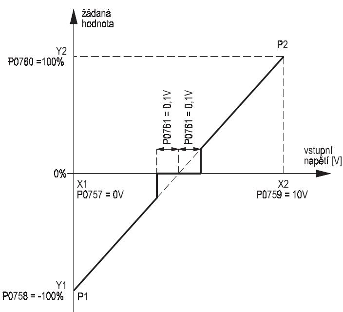
Obr. 36 Nastavení AIN pro zadávání směru otáčení analogovým signálem
