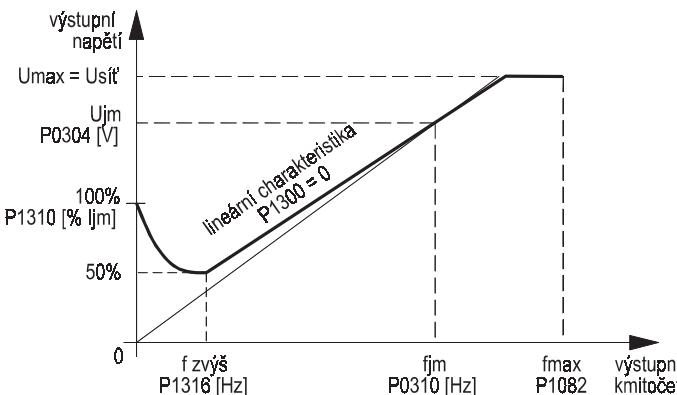
Obr. 54 Lineární charakteristika U/f
