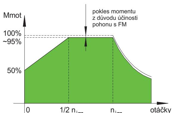
Obr. 17 Redukce zatěžovacího momentu motoru s vlastní ventilací
