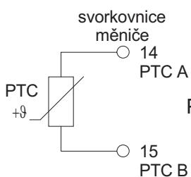
Obr. 18 Zapojení PTC motoru
