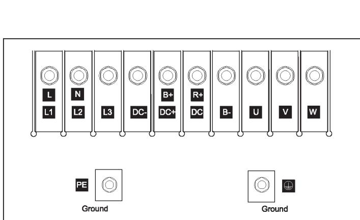
Obr. 8 Silová svorkovnice měničů velikosti D a E
