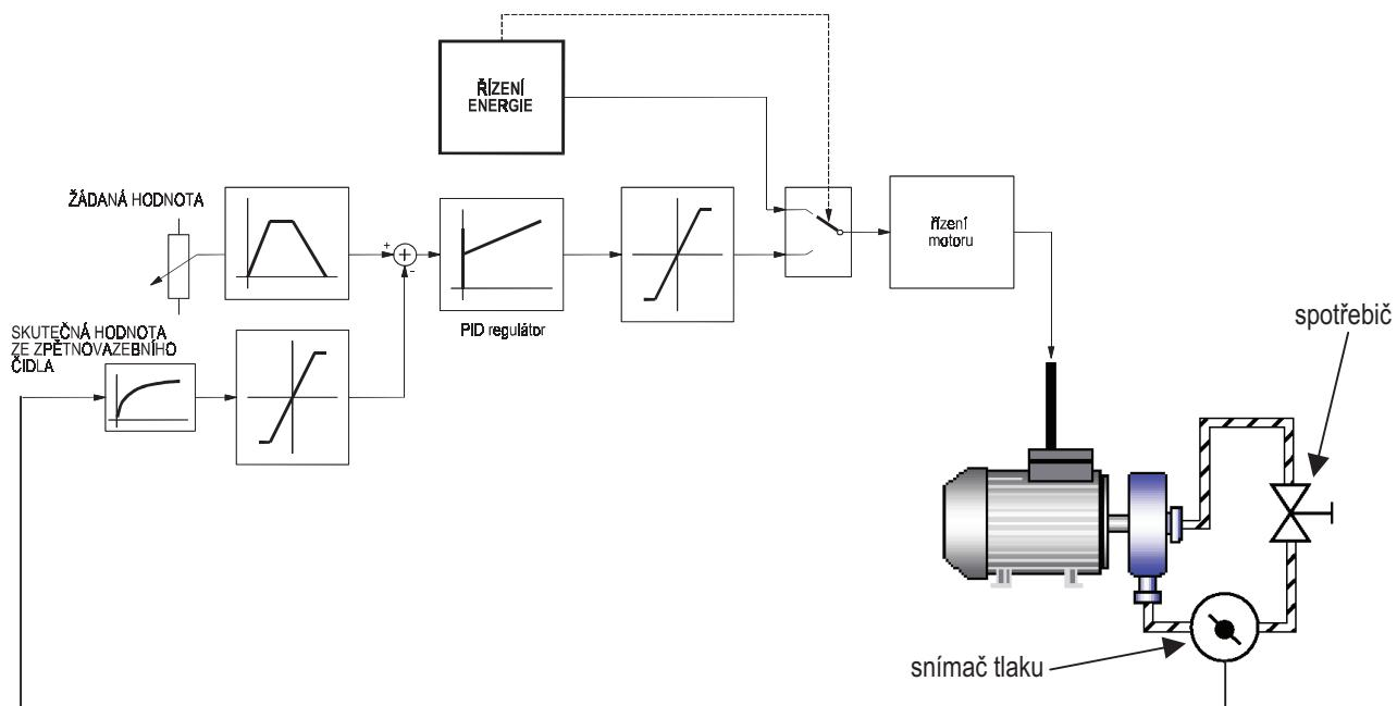
Obr. 29 Principiální schéma režimu úspory energie
