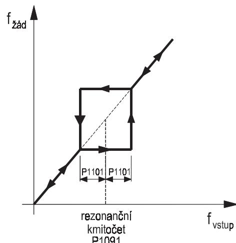
Obr. 43 Potlačení rezonančního pásmá
