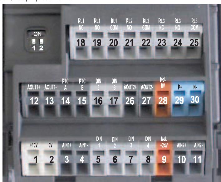
Obr. 14 Řídicí svorkovnice
