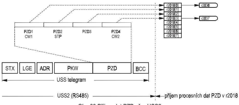
Obr. 68 Příjem dat PZD přes USS2
