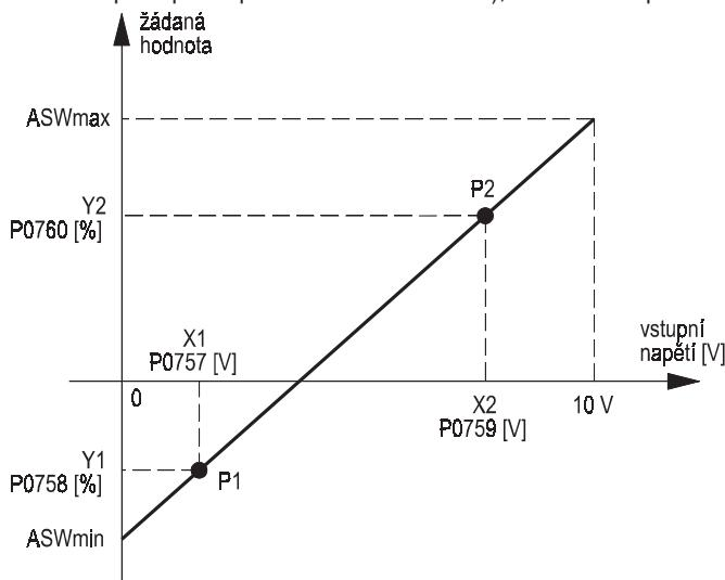
Obr. 34 Normování analogového vstupu AIN
