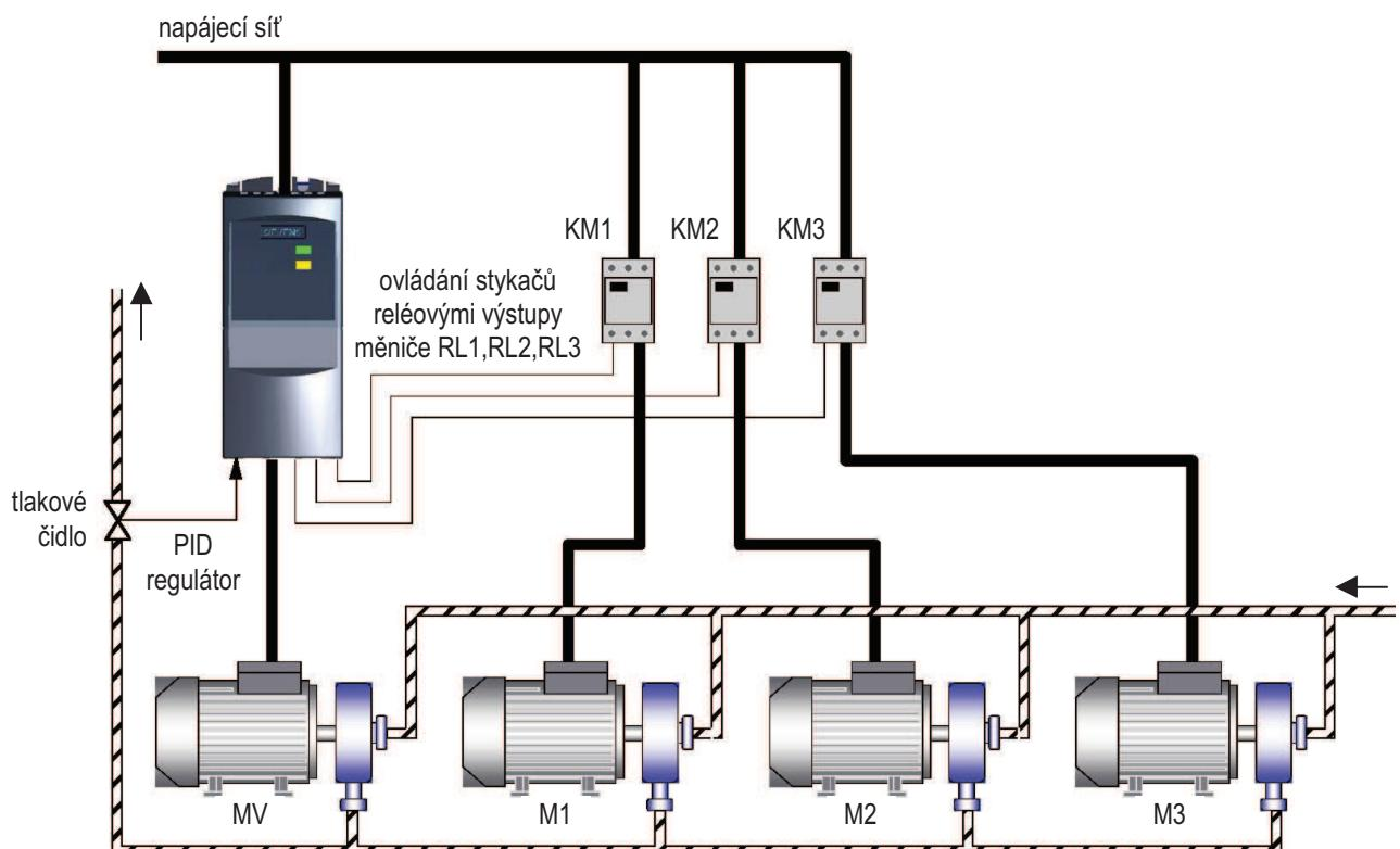
Obr. 28 Principiální schéma řízení kaskády čerpadel
