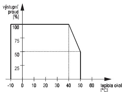
Obr. 1 Graf přípustné provozní teploty měniče
