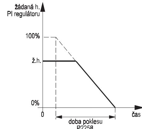
Obr. 83 Doba poklesu žádané hodnoty PID regulátoru
