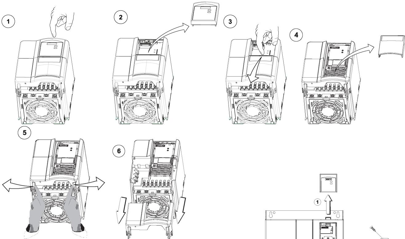
Obr. 11 Odejmutí krytů svorkovnic měniče velikosti C
