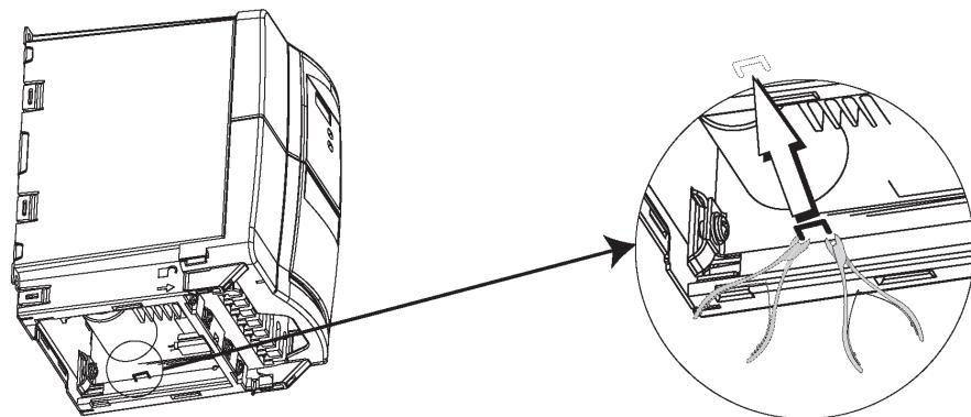
Obr. 4 Propojka Y kondenzátoru u měničů velikosti C
