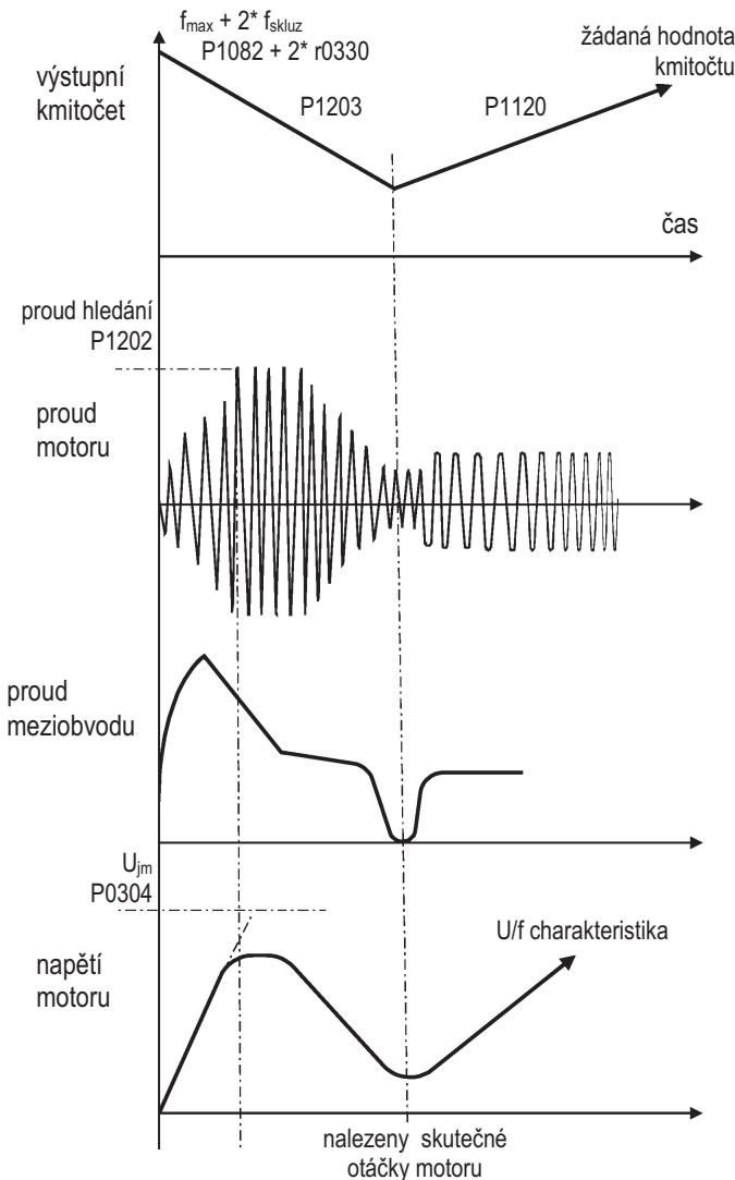
Obr. 48 Synchronizace na otáčející se motor
