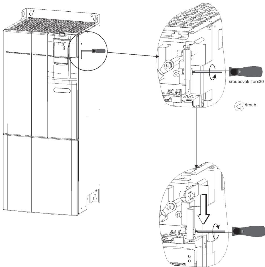
Obr. 6 Odpojení kondenzátoru Y u měniče velikosti F
