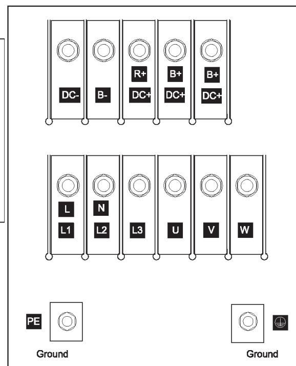
Obr. 9 Silová svorkovnice měničů velikosti D a E
