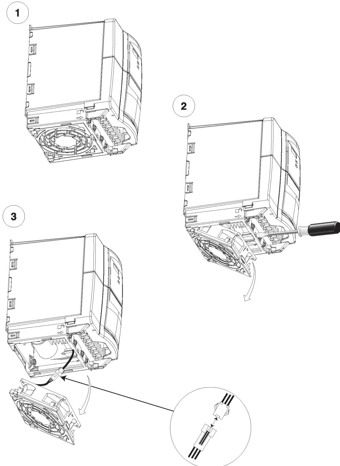
Obr. 88 Demontáž chladicího ventilátoru měniče vel. C
