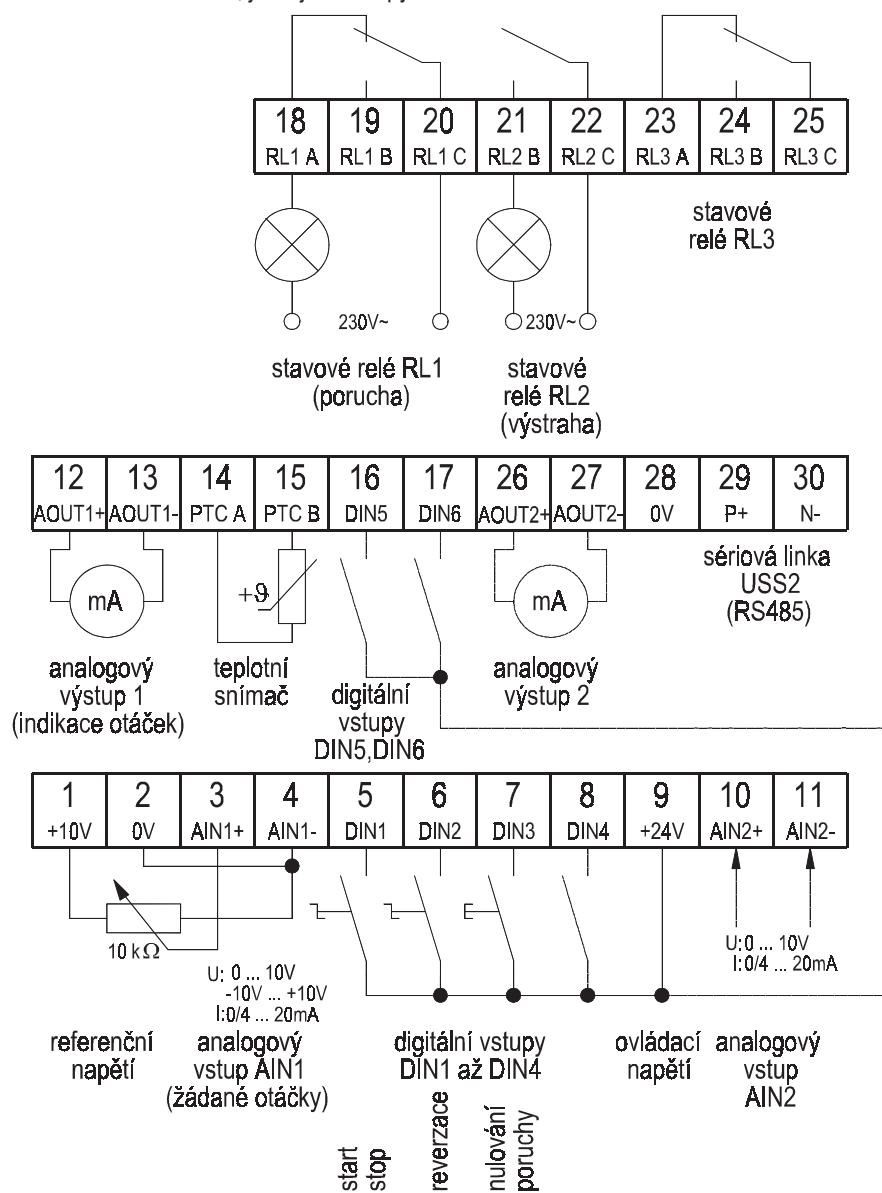
Obr. 24 Význam svorek při továrním nastavení měniče
