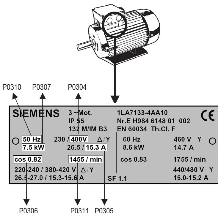
Obr. 25 Výrobní štítek motoru
