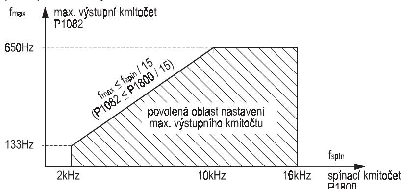
Obr. 42 Maximální výstupní kmitočet měniče
