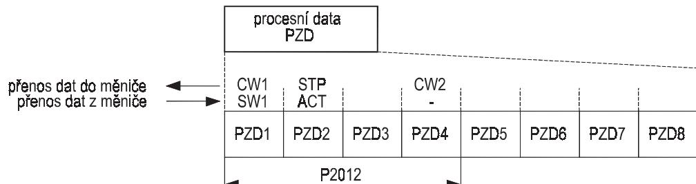
Při propojení mezi měničem a panelem BOP-2 jsou přenášena:
