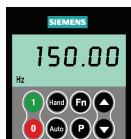
Pokud se vyskytne poruchové nebo výstražné hlášení, na displeji ovládacího panelu BOP-2 se zobrazí symbol **F** nebo **A** a kód poruchového nebo výstražného hlášení.
