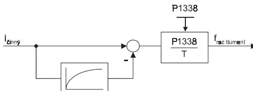
Obr. 60 Rezonanční tlumení
