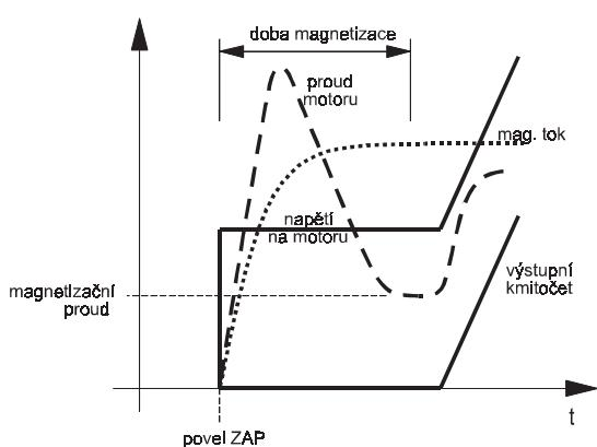
Obr. 61 Skokový nárůst magnetizačního napětí
