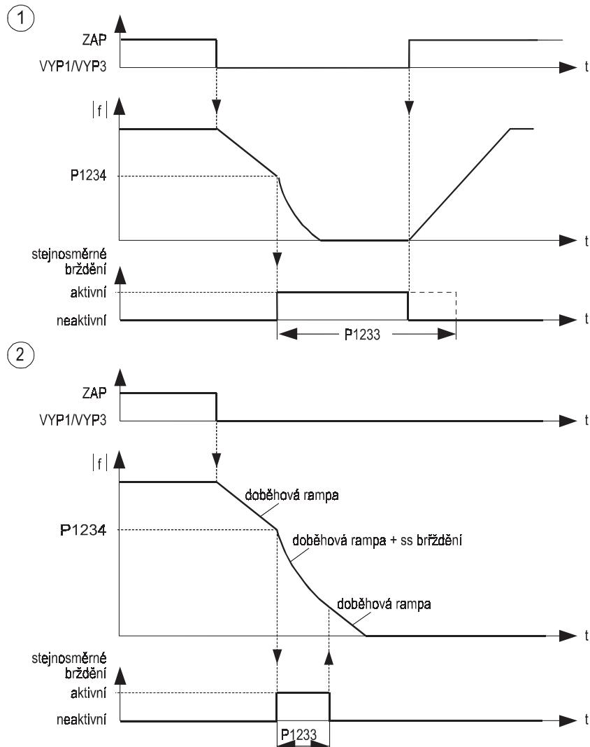
Obr. 52 Stejnosměrné brždění po povelu VYP1 nebo VYP3
