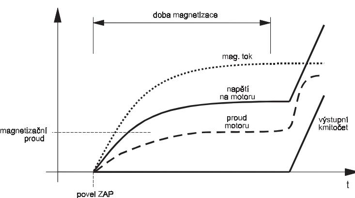
Obr. 62 Pozvolný nárůst magnetizačního napětí
