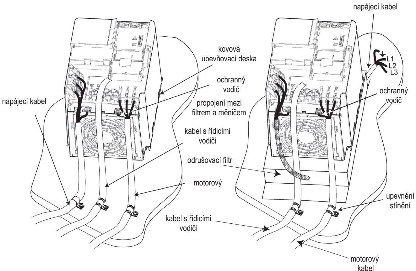
Obr. 21 Způsob propojení měniče z hlediska EMC
