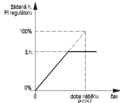
Obr. 82 Doba náběhu žádané hodnoty PID regulátoru
