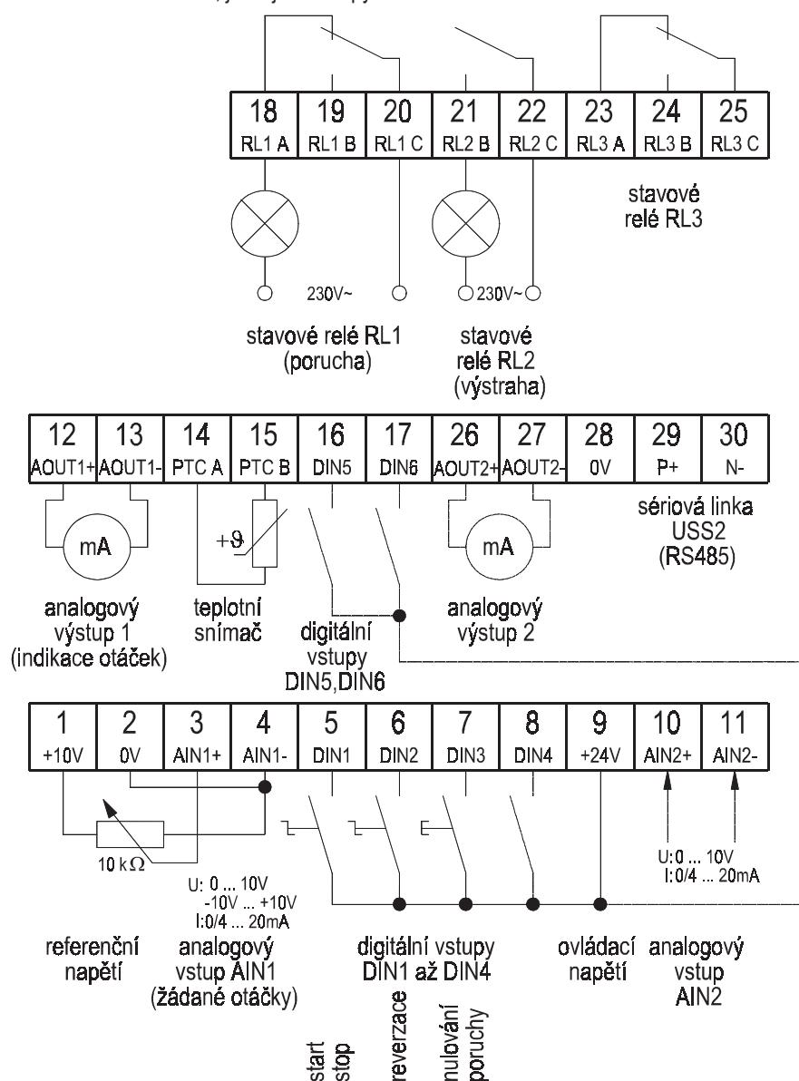
Obr. 32 Význam svorek při továrním nastavení měniče
