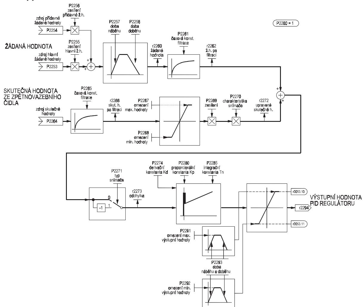
Obr. 111 Schéma technologického PID regulátoru
