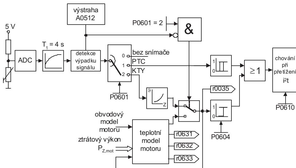
Obr. 44 Teplotní ochrana motoru
