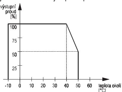
Obr. 2 Provozní teplota měniče  $M \sim n^2$
