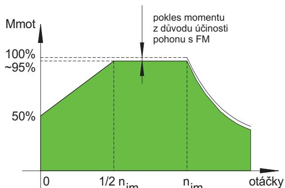
Obr. 23 Redukce zatěžovacího momentu motoru s vlastní ventilací
