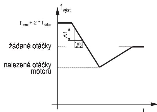
Obr. 69 Rychlos synchronizace na otáčející se motor
