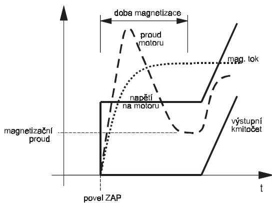
Obr. 81 Skokový nárůst magnetizačního napětí
