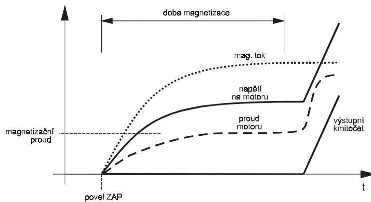
Obr. 82 Pozvolný nárůst magnetizačního napětí
