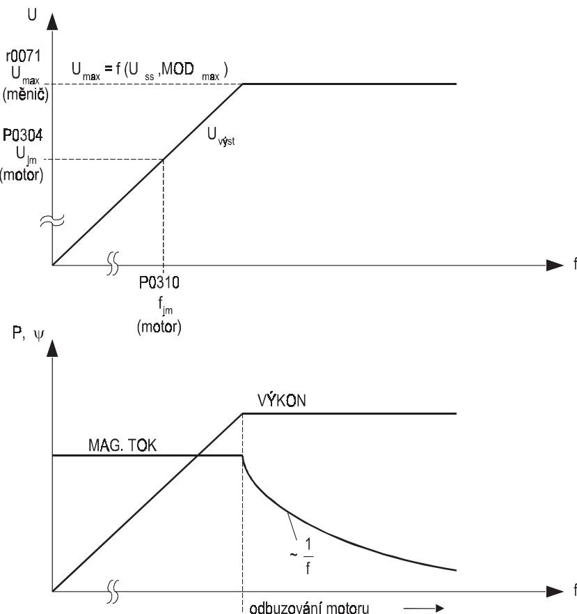
Obr. 39 Výstupní napětí měniče
