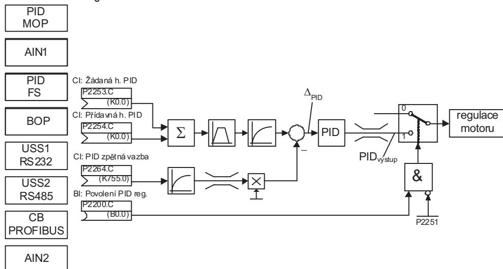
Obr. 113 Volba žádané hodnoty PID regulátoru
