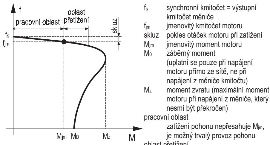
Obr. 78 Momentová charakteristika as. motoru
