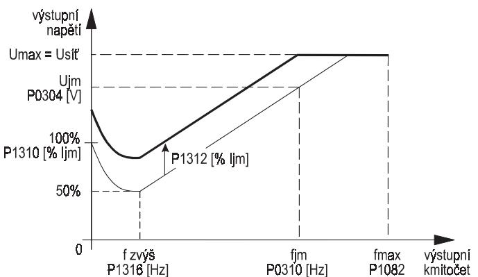
Obr. 76 Posun U/f charakteristiky při rozběhu
