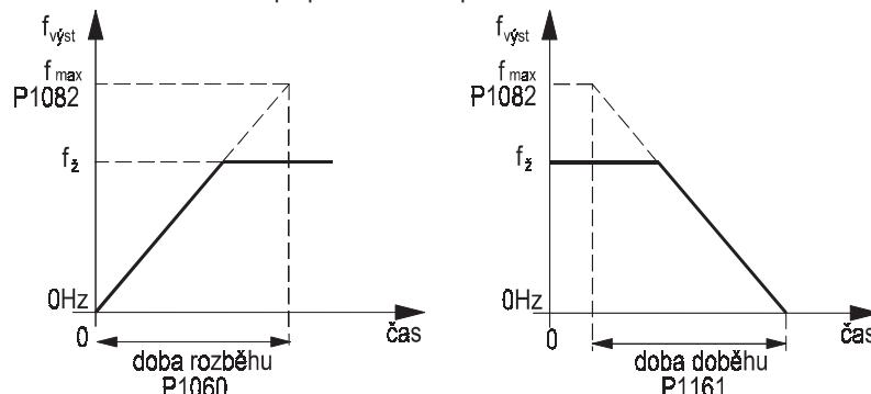
Obr. 59 Doba rozbehu a doběhu při krokování
