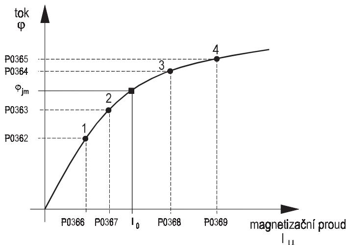
Obr. 43 Saturační magnetizační křivka
