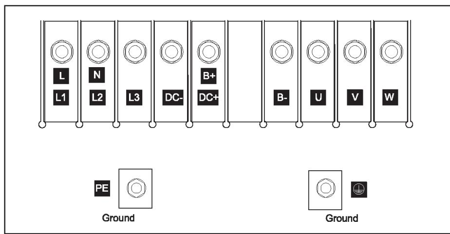
Obr. 12 Silová svorkovnice měničů velikosti D a E
