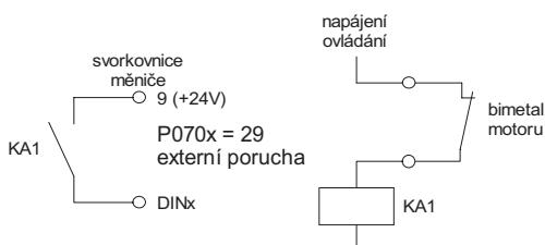
Bimetalový kontakt zapojte do obvodu externí poruchy přes oddělovací relé - na některý z binárních vstupů DIN1 až DIN6 (obr. 24) a příslušný parametr P0701 až P0706 nastavte na hodnotu 29 (funkce externí porucha).
