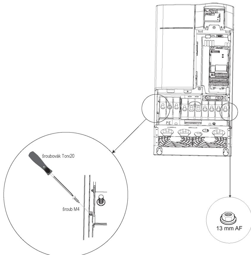
Obr. 8 Odpojení kondenzátoru Y u měničů velikosti D a E
