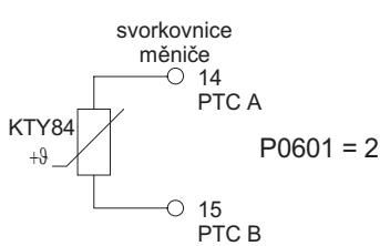
Obr. 26 Zapojení tepl. snímače KTY 84
