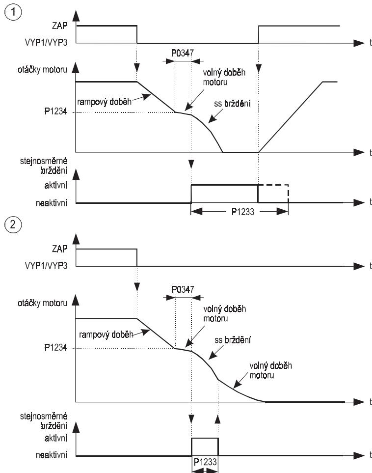
Obr. 72 Stejnosměrné brždění po povelu VYP1 nebo VYP3
