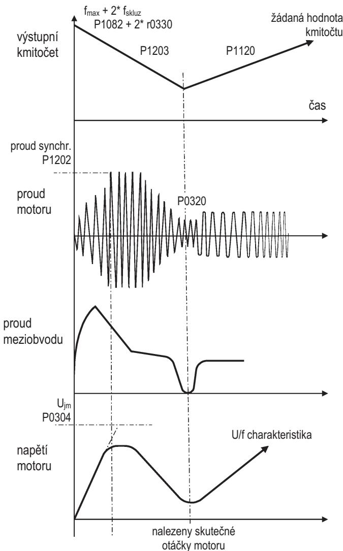
Obr. 68 Synchronizace na otáčející se motor
