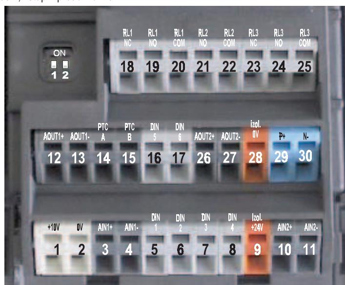
Obr. 20 Řídicí svorkovnice
