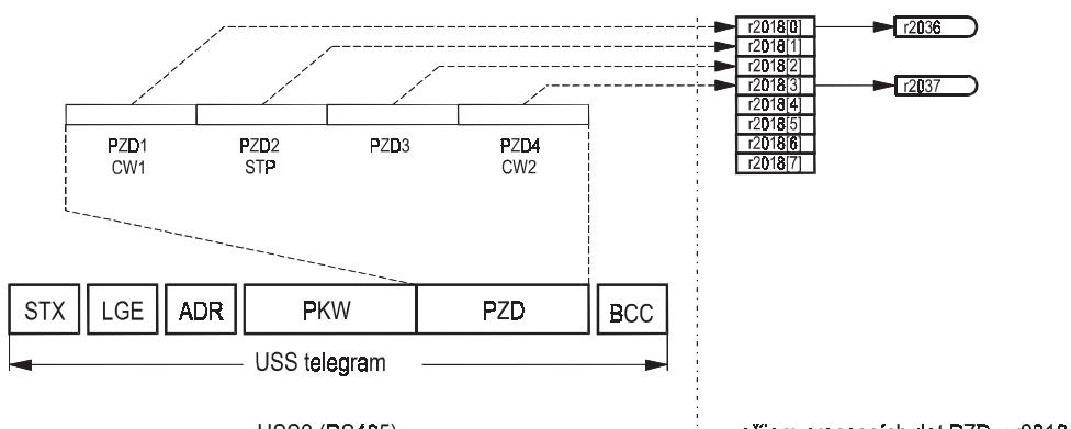
Obr. 96 Příjem dat PZD přes USS2
