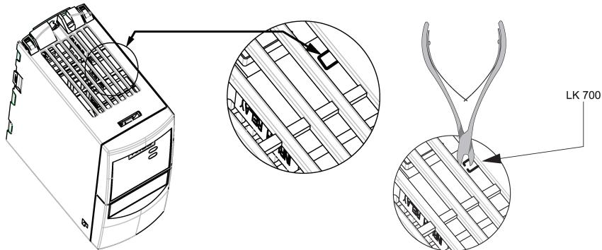
Obr. 6 Propojka LK700 u měniče velikosti A
