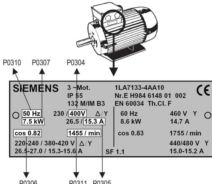
Obr. 33 Výrobní štítek motoru
