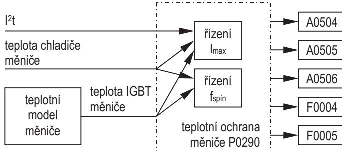
Obr. 41 Teplotní ochrany měniče
