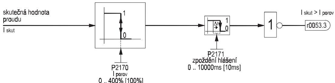
Obr. 106 Porovnání výstupního proudu
