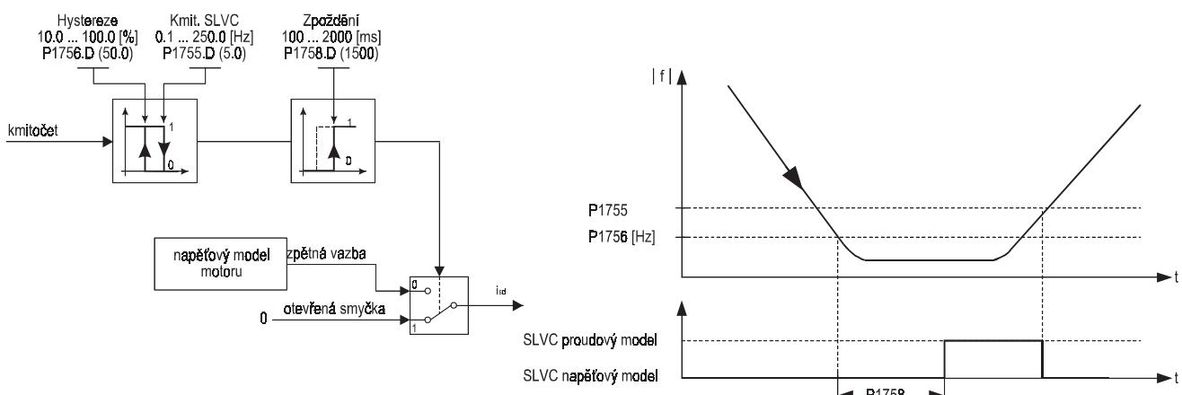
Obr. 90 Přepínání napěťového modelu / proudového modelu SLVC
