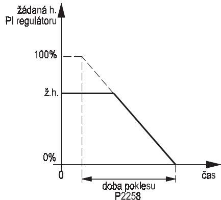
Obr. 115 Doba poklesu žádané hodnoty PID regulátoru
