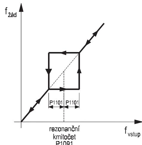
Obr. 63 Potlačení rezonančního pásmá
