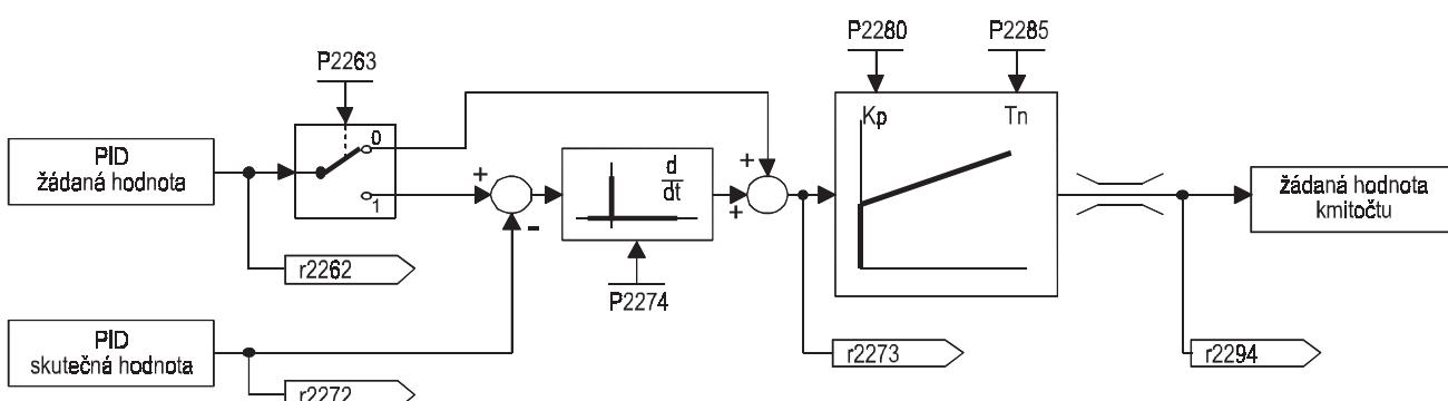
Obr. 116 PID regulátor
