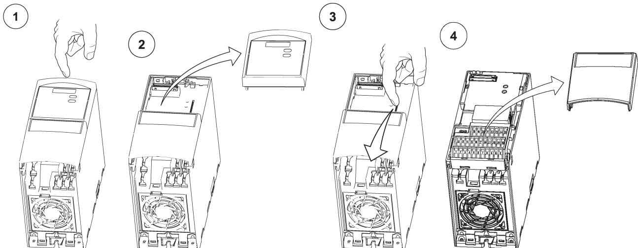
Obr. 15 Odejmutí krytu svorkovnice měniče velikosti A
