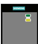
Na ovládacím panelu SDP jsou dvě indikační LED - zelená a žlutá. Kombinací rozsvícení / zhasnutí / blikání LED se rozlišují různé provozní stavy měniče.
