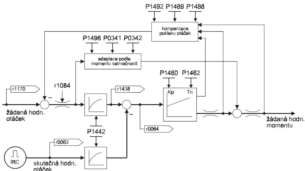
Obr. 83 Otáčkový regulátor - vektorové řízení VC
