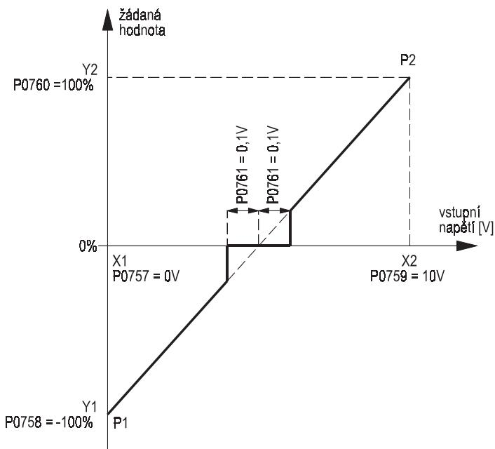
Obr. 50 Nastavení AIN pro zadávání směru otáčení potenciometrem
