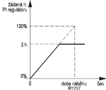
Obr. 114 Doba náběhu žádané hodnoty PID regulátoru
