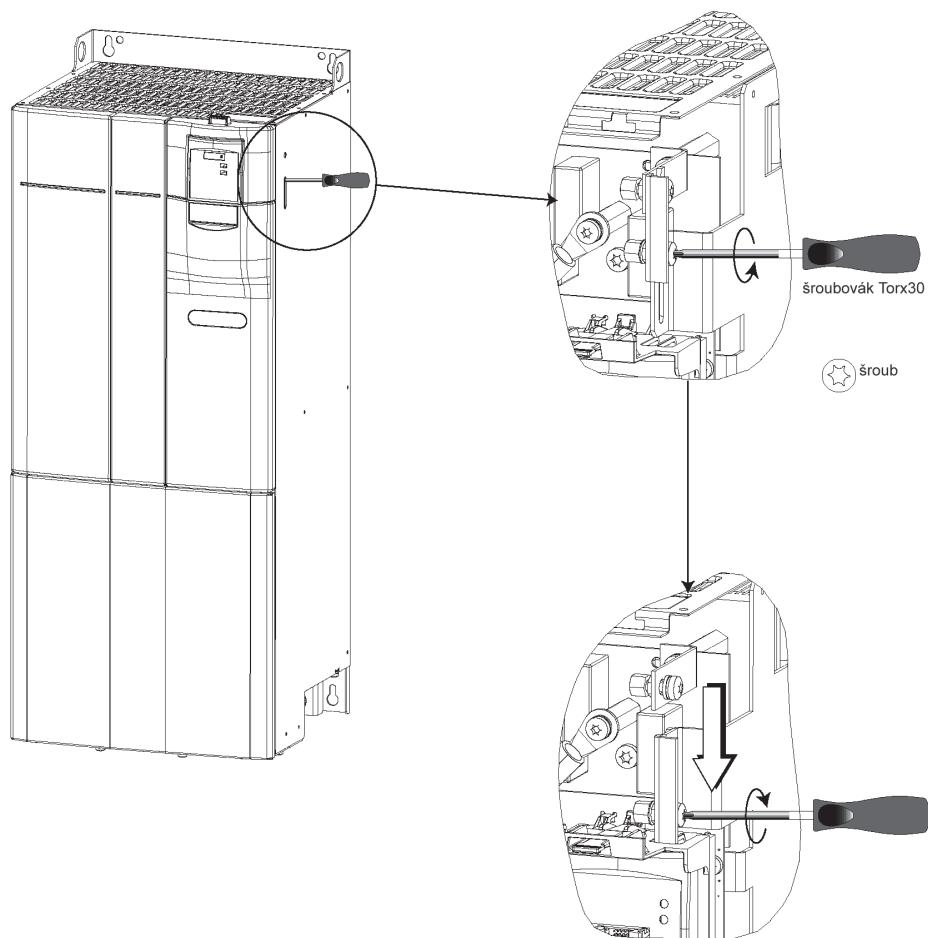
Obr. 9 Odpojení kondenzátoru Y u měniče velikosti F
