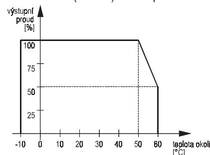
Obr. 1 Provozní teplota měniče  $M = \text{konst.}$
