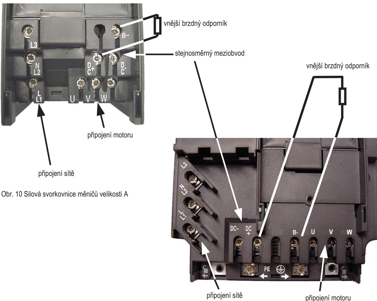
Obr. 11 Silová svorkovnice měničů velikosti B a C
