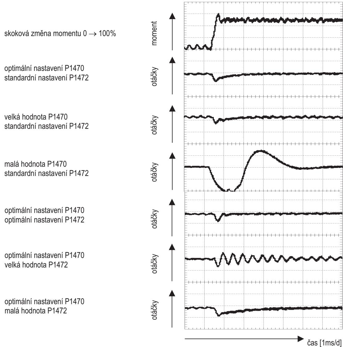
Obr. 84 Nastavení regulátoru vektorového řízení
