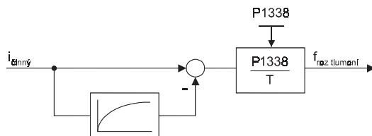
Obr. 80 Rezonanční tlumení
