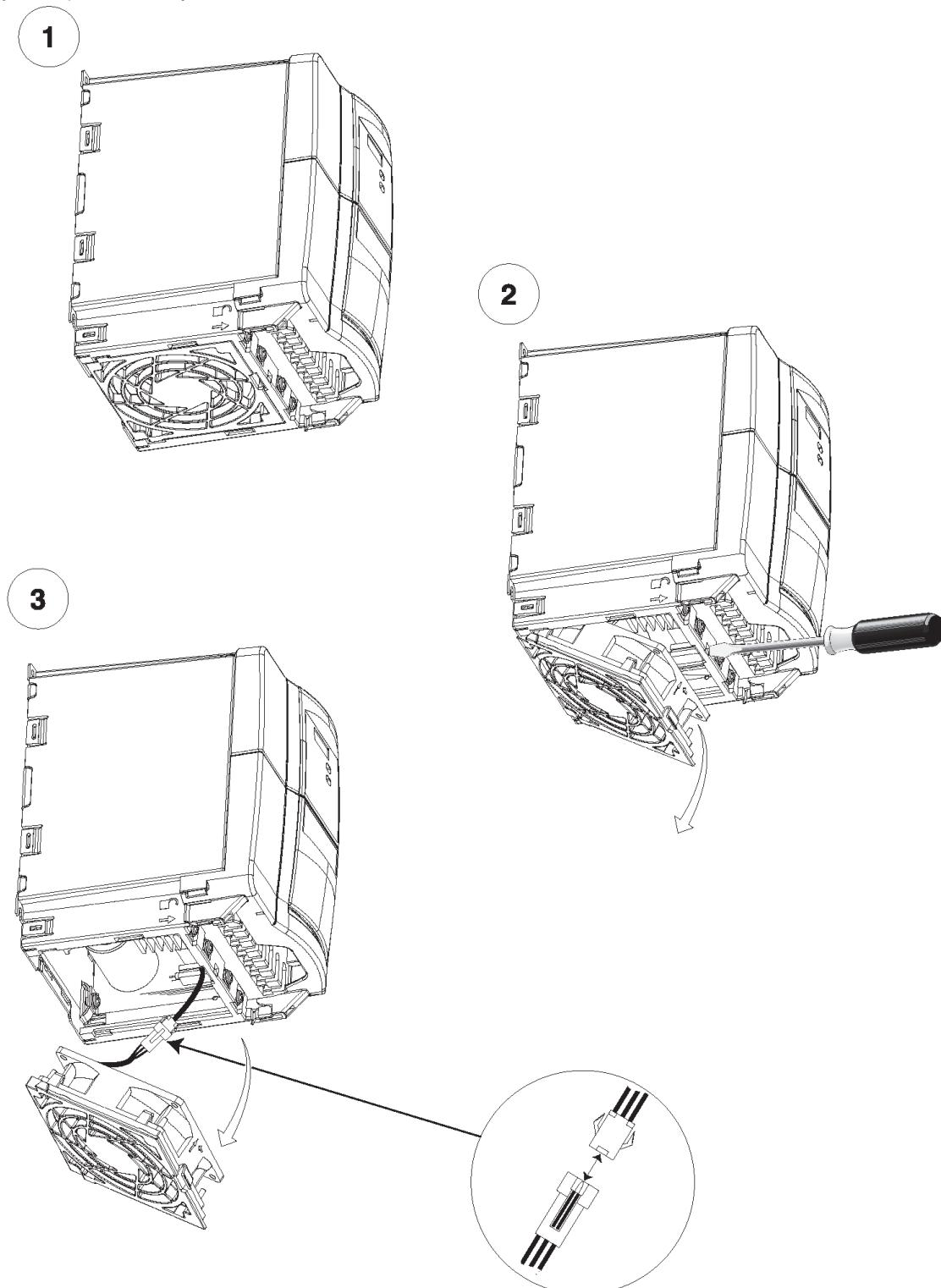
Obr. 122 Demontáž chladicího ventilátoru měniče vel. B, C
