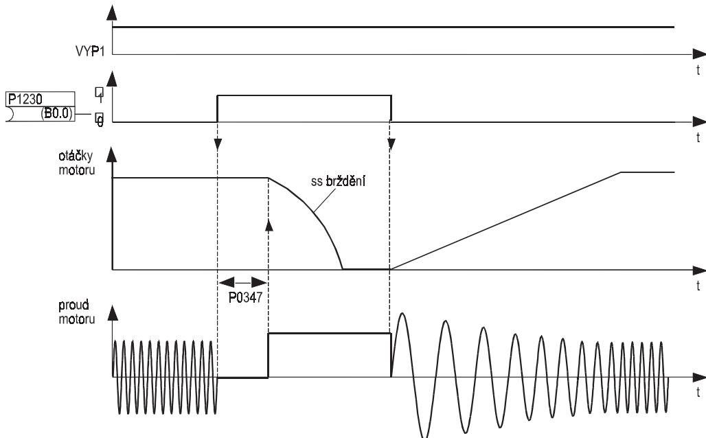
Obr. 71 Stejnosměrné brždění motoru
