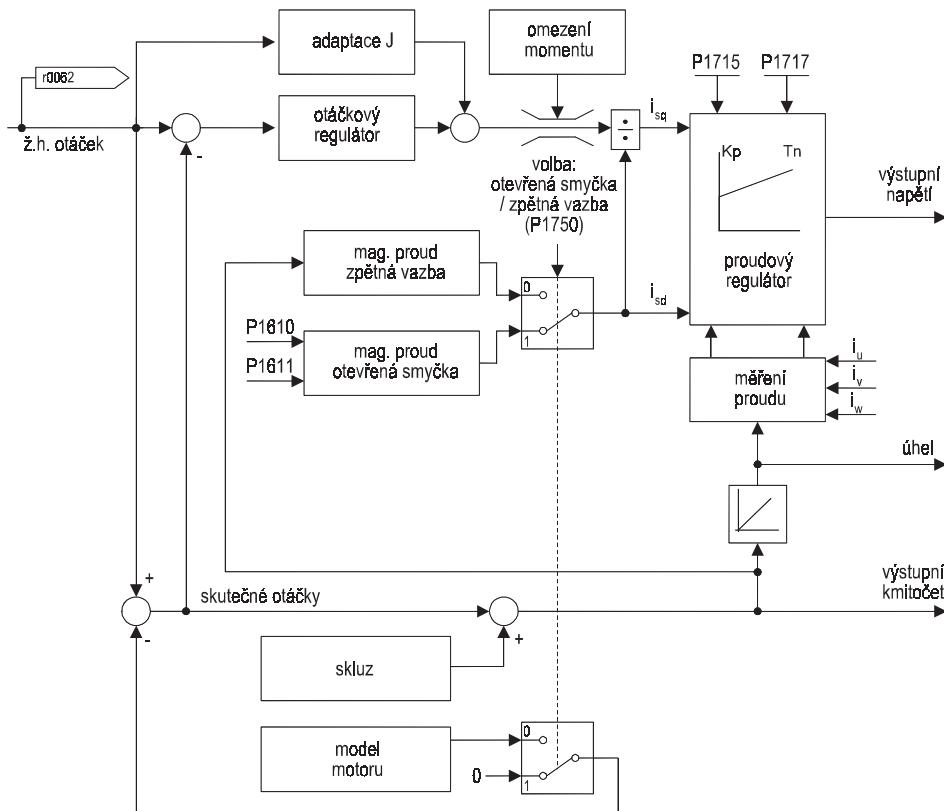
Obr. 88 Proudový regulátor a řízení magnetizačního proudu
