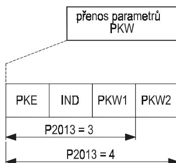
Obr. 93 Přenos hodnot parametrů PKW
