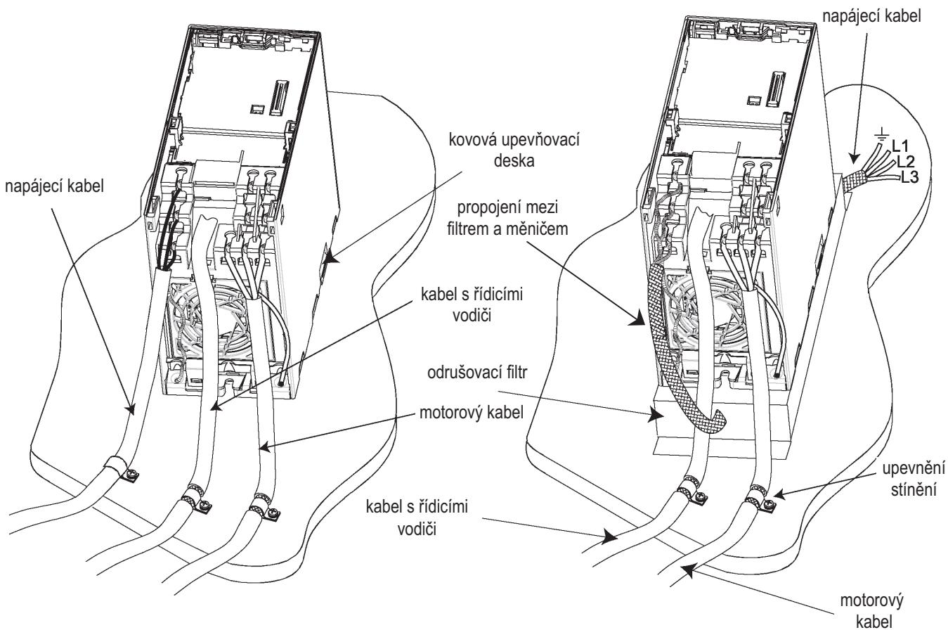
Obr. 28 Způsob propojení měniče z hlediska EMC
