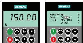
Pokud se vyskytne poruchové nebo výstražné hlášení, na displeji ovládacího panelu BOP se zobrazí symbol **F** nebo **A** a kód poruchového nebo výstražného hlášení.
