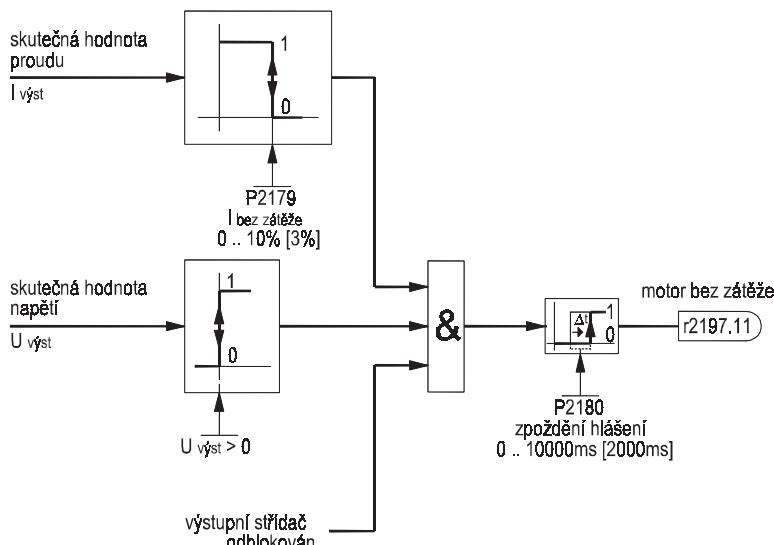
Obr. 109 Hlídání odlehčení motoru
