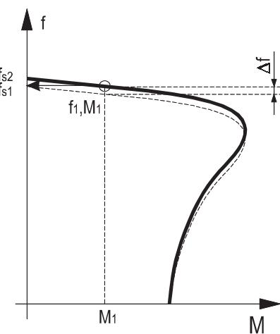
Obr. 79 Kompenzace skluzu as. motoru
