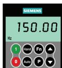
Pokud se vyskytne poruchové nebo výstražné hlášení, na displeji ovládacího panelu BOP-2 se zobrazí symbol **F** nebo **A** a kód poruchového nebo výstražného hlášení.
