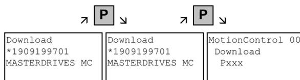
Tlačítkem „RESET“ je možné proces přenosu parametrů v každém okamžiku přerušit. Podaří-li se úspěšně přenést funkcí Download všechny parametry do měniče, objeví se hlášení "Download ok" a zobrazí se základní menu.
